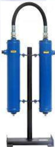
Фильтрационный модуль предназначен для тонкой очистки сжатого воздуха и различных газов от аэрозолей масла и влаги, а также от твердых частиц размером более 3 мкм. Обеспечиваемое остаточное содержание аэрозоля масла - менее 5 мг/м<sup>3</sup>. Используется в системах пневмоуправления и автоматики, пневмоприводе устройств и инструмента для окраски поверхностей распылением.
